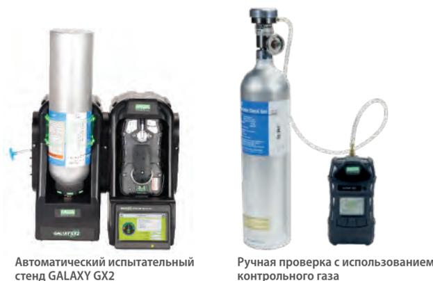
Автоматический испытательный стенд GALAXY GX2
